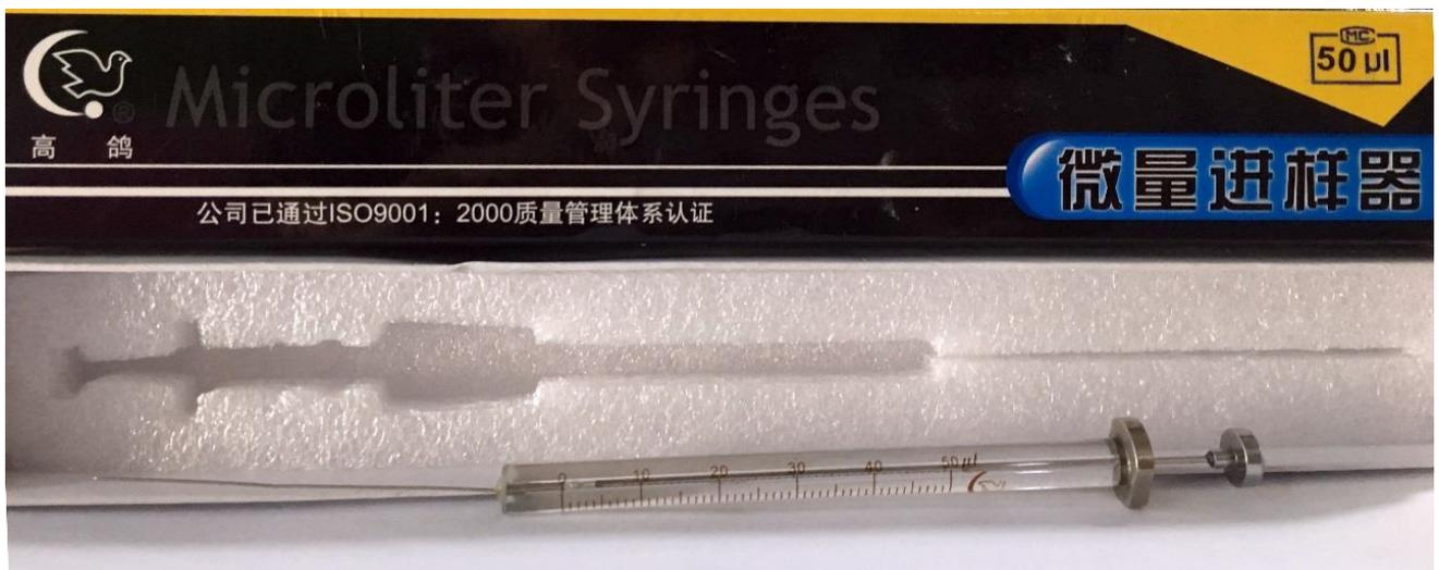
图 8. 50uL 微量进样器照片
